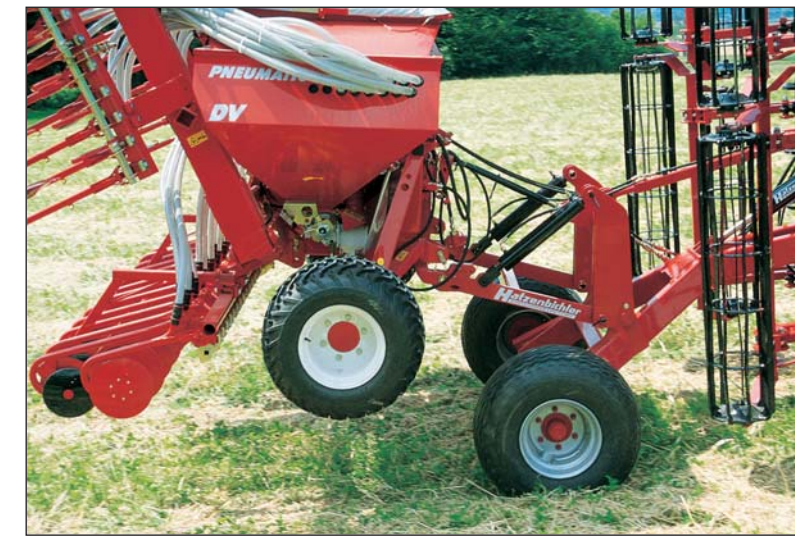
Robust ausgeführte 3-Punkt-Hydraulik für die Sämaschine (hohe Aushubhöhe)
