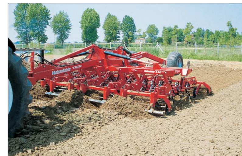
Das spindelverstellbare Planierschild ebnet den Boden gleichmäßig ein.
