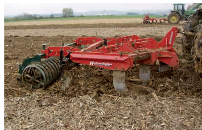
Tiefenlockerer „DELTA“ 5 Zinken mit Zwischenzinken und Keilringwalze, Tiefenlockerung und Stoppelsturz in einem Arbeitsgang
