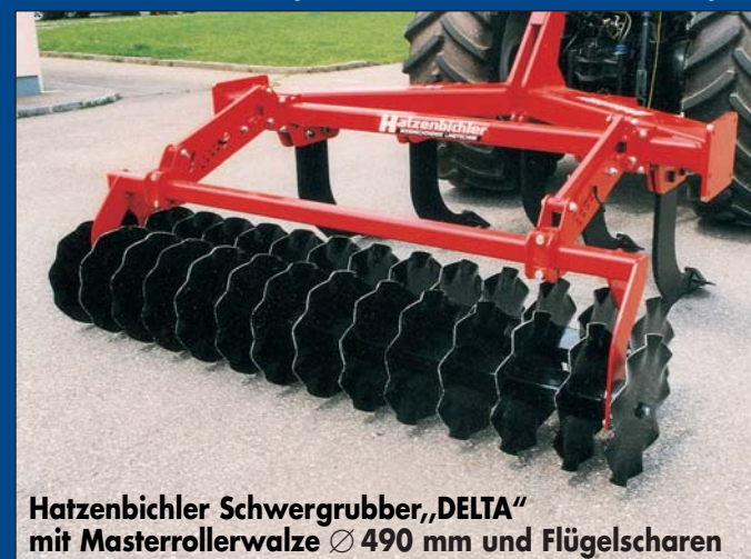
Hatzenbichler Schwergrubber „DELTA“ mit Rohrstabwalze Ø 495 mm u. Meisselscharen
