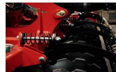
Federbelasteter Nachkrümelstrielgel folgt den Arbeitswerkzeugen
