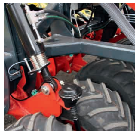
Tiefeneinstellung des Reifenpackers mittels Distanzscheiben am Hydraulizylinder
