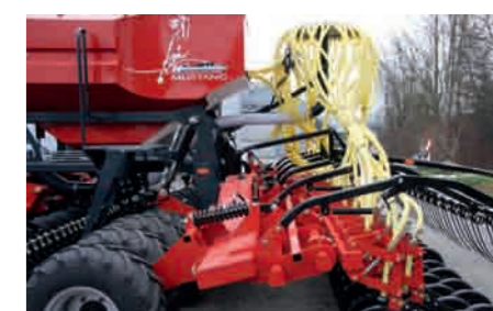
Hydraulizylinder mit Distanzscheiben zum Verstellen des Neigungswinkels bzw. der Arbeitstiefe
