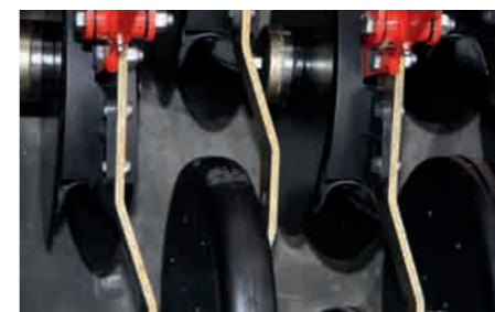
Gummiabstreifer mit eingefassten Hartmetallkanten sorgen für einen reibungslosen Säablauf
