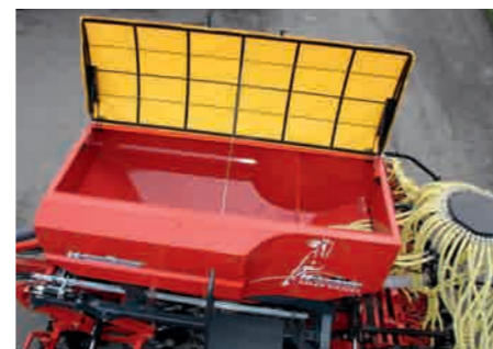
Große Einfüllöffnung am Sätank, Abdeckung des Tanks lässt sich durch Gasdruckzylinder einfach öffnen
