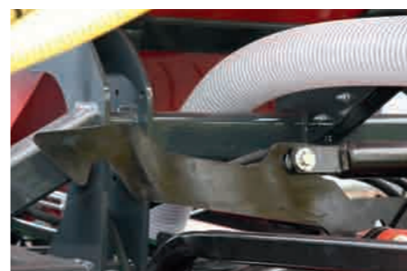
Automatische Transportverriegelung der Sänschiene mittels Hydraulizylinder
