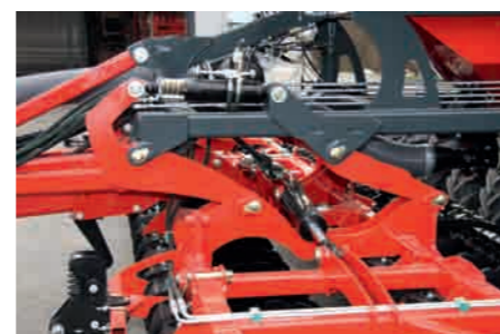
Einstellen der Arbeitstiefe mittels Distanzscheiben am Hydraulizylinder, paralleles Ausheben und Absenken der Arbeitswerkzeuge, keine Verstellung des Angriffs- bzw. Schnittwinkels der Arbeitswerkzeuge
