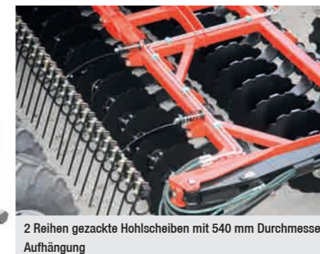
Federbelasteter Nachkrümelstrielgel folgt den Arbeitswerkzeugen
