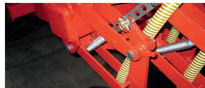
Parallelogrammgeführte Doppelscheibenschare mit Druckrollen und Nachkrümelstrielgel
