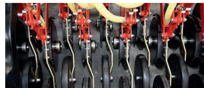
Parallelogrammgeführte Doppelscheibenschare, Reihenabstand 12,5 cm
