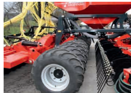
Für eine gute Rückverfestigung sind die Reifenpacker auf den Seitenarmen zusätzlich federbelastet
