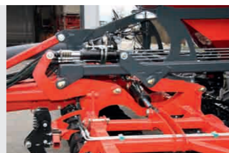
Einstellen der Arbeitstiefe mittels Distanzscheiben am Hydraulizylinder, paralleles Ausheben und Absenken der Arbeitswerkzeuge, keine Verstellung des Angriffs- bzw. Schnittwinkels der Arbeitswerkzeuge
