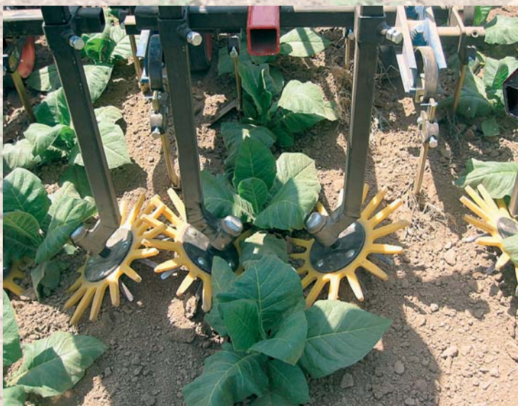
Sehr hohe Lebensdauer durch kugelgelagerte, schmierbare Hacksterne.
