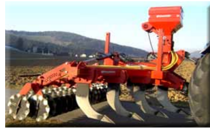
„Delta“ 5 Zinken mit pneum. Sägerät „Air 8“
