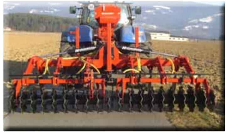
„Delta“ mit Masterrollerwalze und pneum. Sägerät „Air 8“
