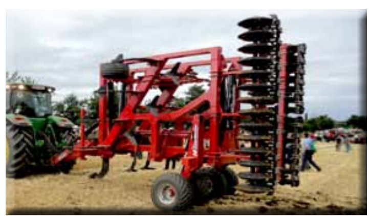
„Delta“ 9 Zinken mit hydr. Klappung in Transportstellung
