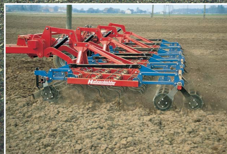
Das gefederte Planierschild sorgt für die optimale Einebnung des Saatbeetes.
